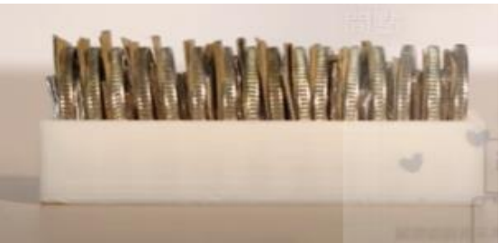
利用鋁箔、一元硬幣、紙片製作電池
